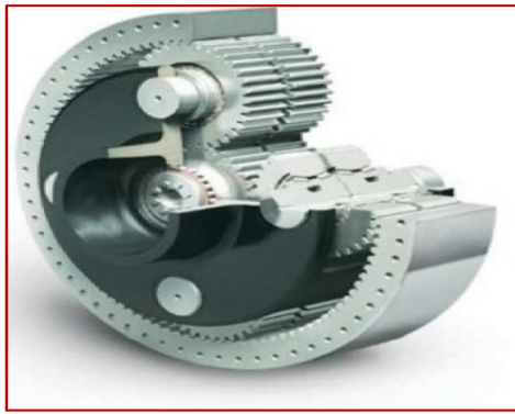
Figure II.6 : Modèle mécanique du multiplicateur.
