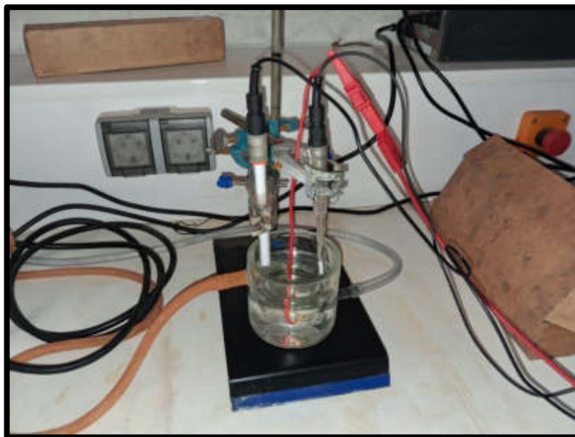
Figure II.15: Dispositif expérimental de trois électrodes.
