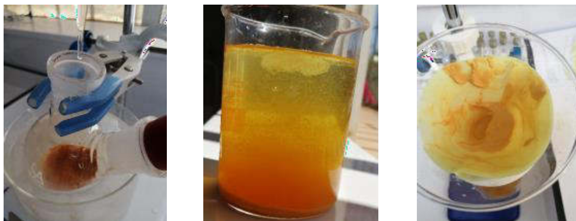
Figure II.14 : Préparation de l'acide 3,5-dinitrosalicylique (DNS)
