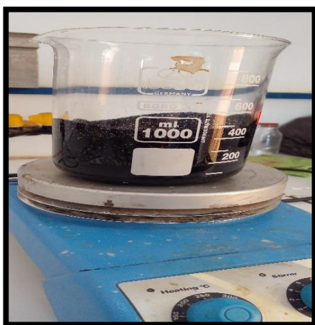
Figure III.7 : Agitation du charbon Avec H_3PO_4 (4heure).
