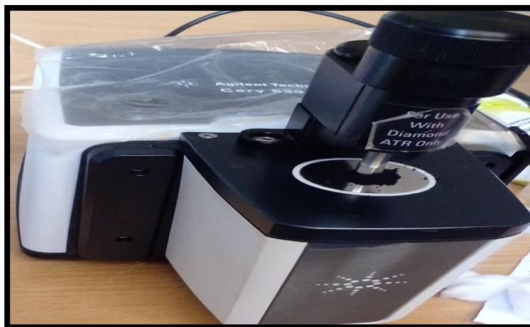
Figure III.4 : Spectrophotomètre infra-rouge à transformée de Fourier Agilent Cary 630.
