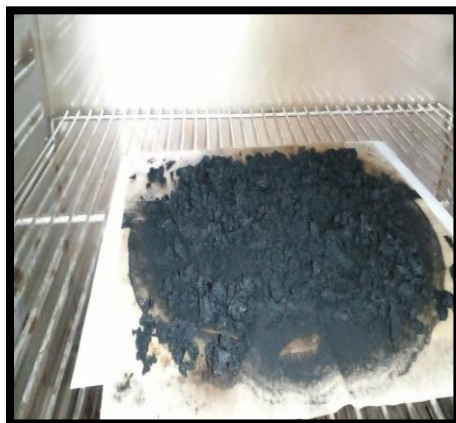
Figure III.9 : Séchage de charbon actif à 100°C.
