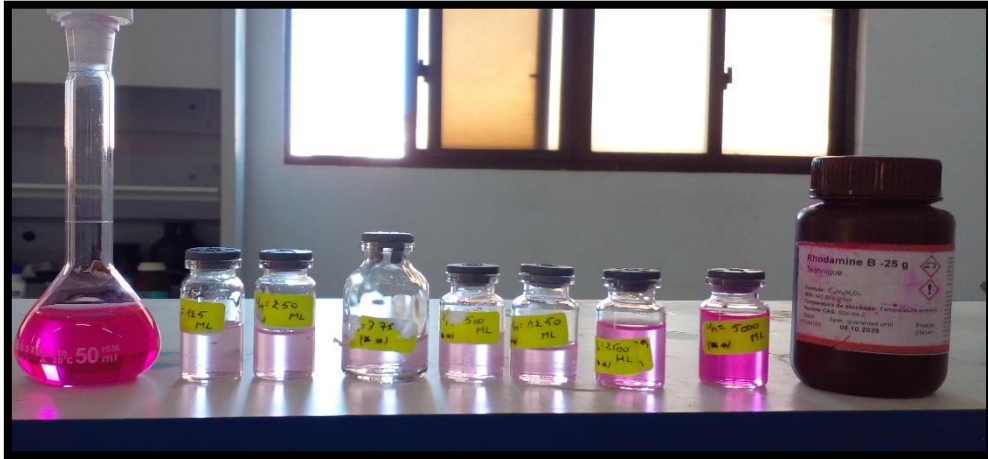
Figure III.12 : Préparation des solutions diluées de la Rhodamine B.
