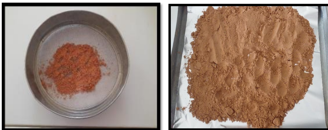
Figure III.3 : Broyage et tamisage des noyaux de dattes.
