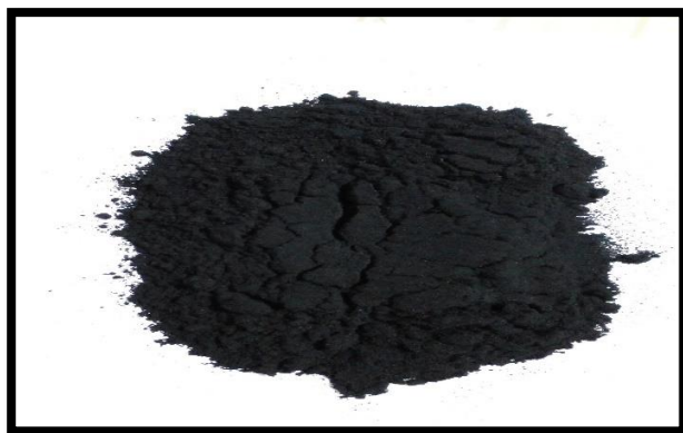
Figure III.6 : Charbon actif préparé à partir des noyaux de dattes.
