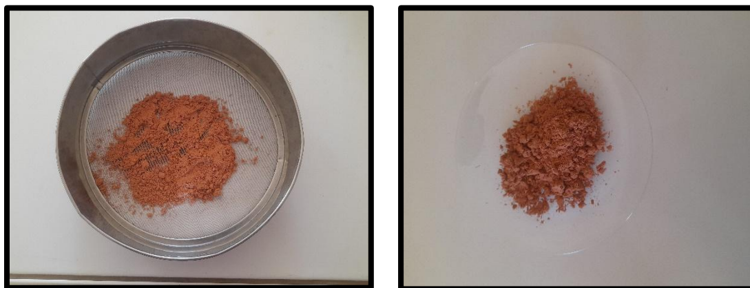
Figure III.5: Broyage et tamisage des noyaux de dattes.
