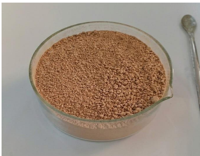
Figure I.6 : Coques de noyaux de pêches concassées et séchées
