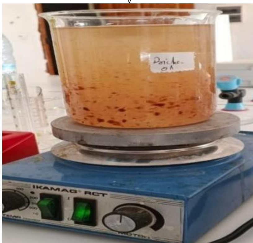
Figure I.8 : Lavage de purification sous agitation magnétique (Suivi du pH)
