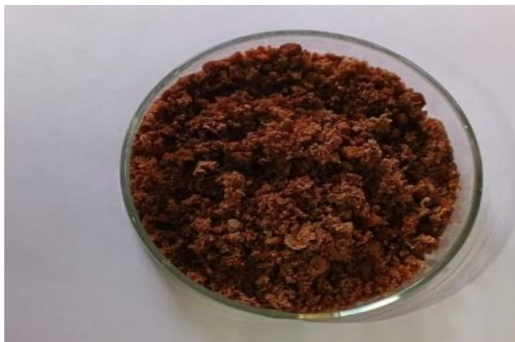
Figure I.9 : Poudre humide apres decantation et filtration
