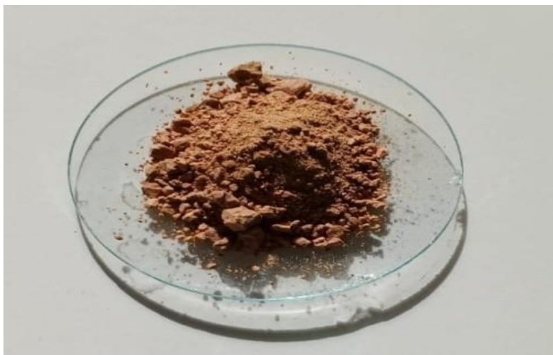
Figure I.7 : Poudre brute obtenue après broyage mécanique
