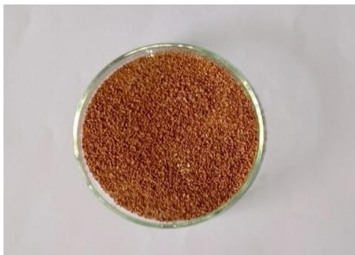
Figure I.10 : Poudre finale de noyaux de pêches purifiée, tamisée et prête a l'emploi.
