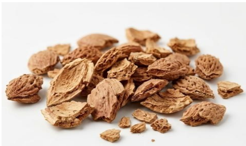
Figure I.5 : Coques de noyaux de pêches après concassage
