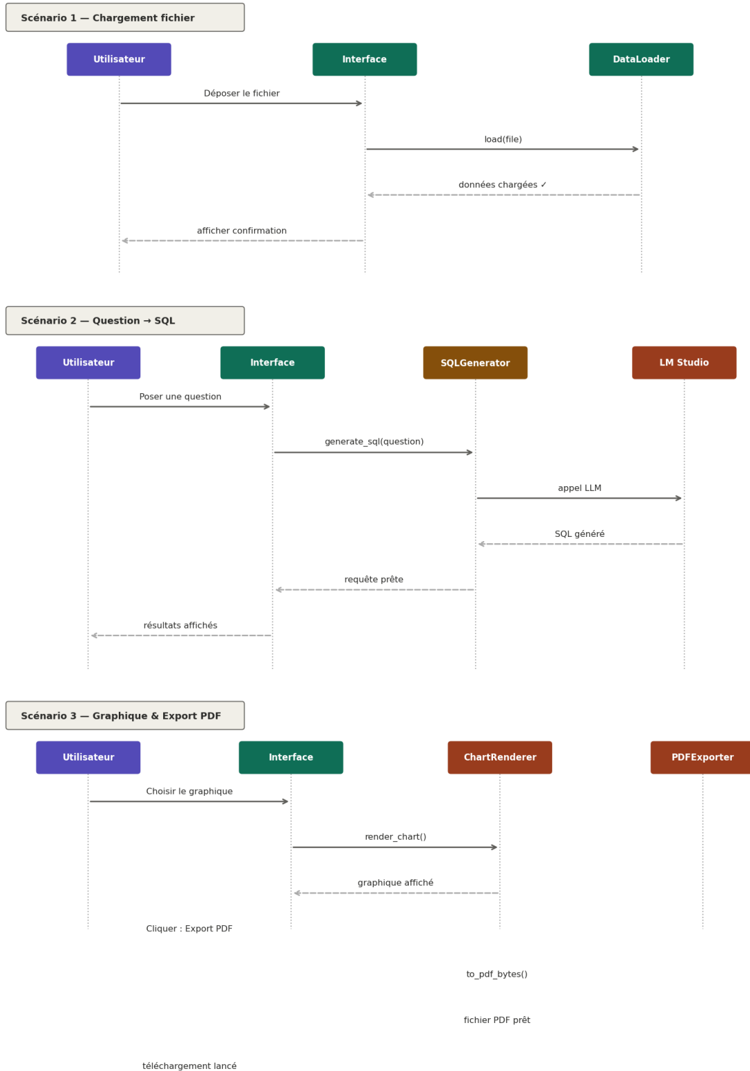
FIG. 5.3 : Diagrammes de séquence — trois scénarios principaux
