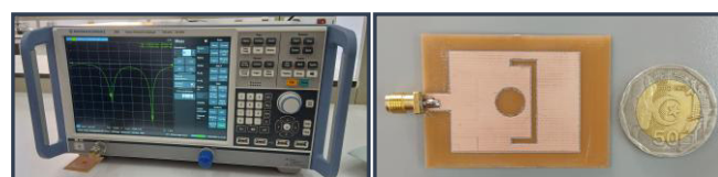
Figure 3-10 : Circuit Réalisé d'Antenne Patch Dual-Bande Optimisée Sous SSFH
