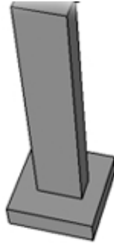
Figure V.8. Poteaux en béton armé d'une section rectangulaire
