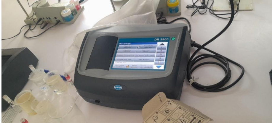
Figure III.10 : Spectrophotomètre de type HACH DR 3900
