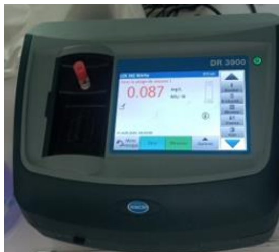
Figure III.14 : Spectrophotomètre DR 3900 pour la mesure de la concentration des nitrites ( \text{NO}_2^- )
