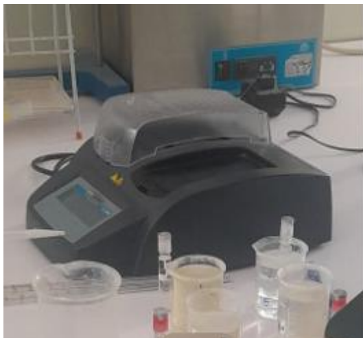
Figure III.11 Réacteur d'oxydation de la DCO
