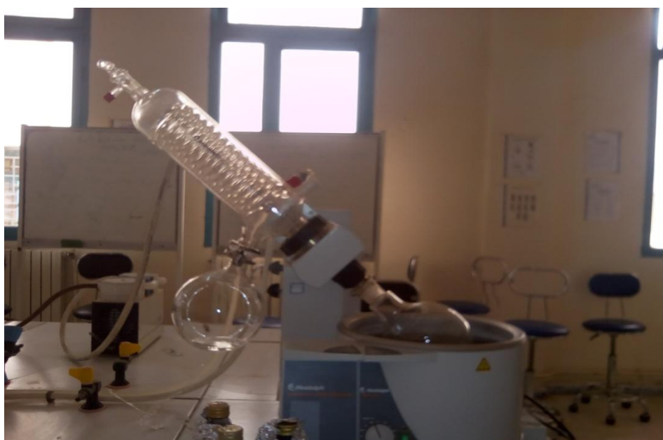
Figure 11 : rota vapeur (BUCHI Rota vapeur R-200) utilisé pour la concentration des métabolites secondaires.
