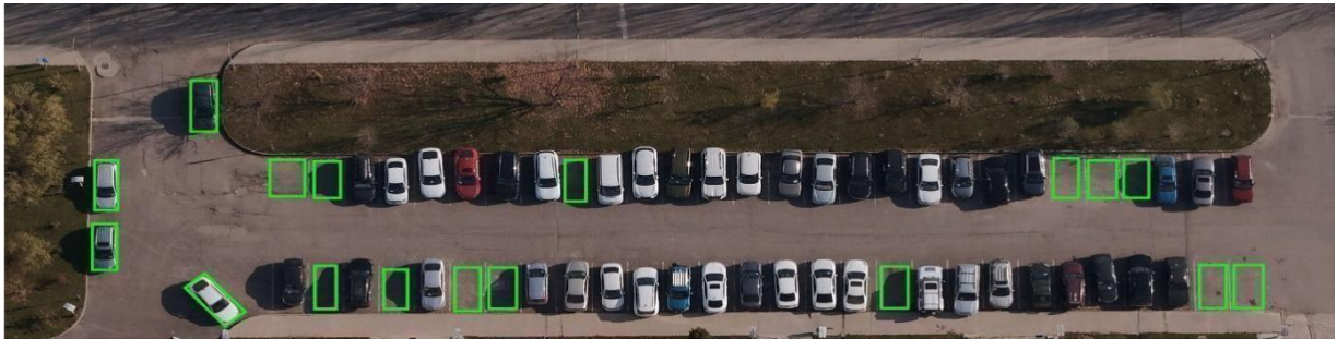
Figure III.4 : Identification des places de stationnement libres et occupées [35]
