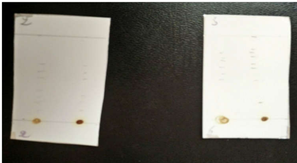
Figure 30: migration du solvant par capillarité vers le haut sur plaque CCM
