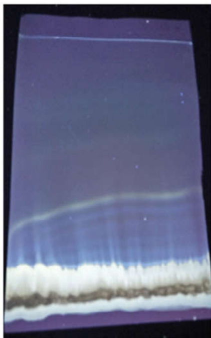
Chromatogramme de l'extrait méthanolique de l'isolat A10 à 365 nm (UV) (Fluorescence)
