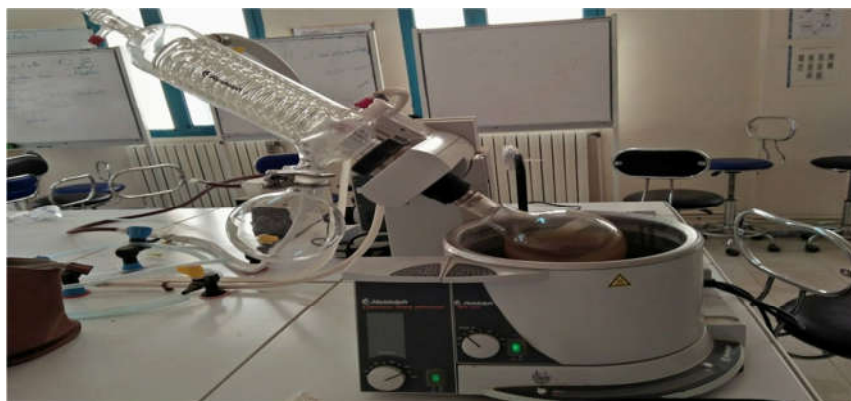
Figure 29 : concentration des extraits par évaporation au rota vapeur à 40°C
