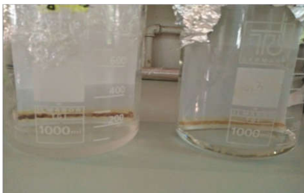
Figure 31 : semi purification des extraits sur couche mince de silice
