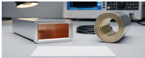
Figure II. 5: Exemple des guides d'onde. (a) guide d'onde rectangulaire, (b) guide d'onde circulaire.
