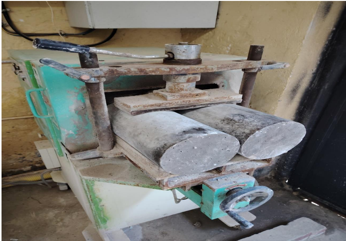
Figure IV-2 : Principe du surfaçage l'éprouvette
