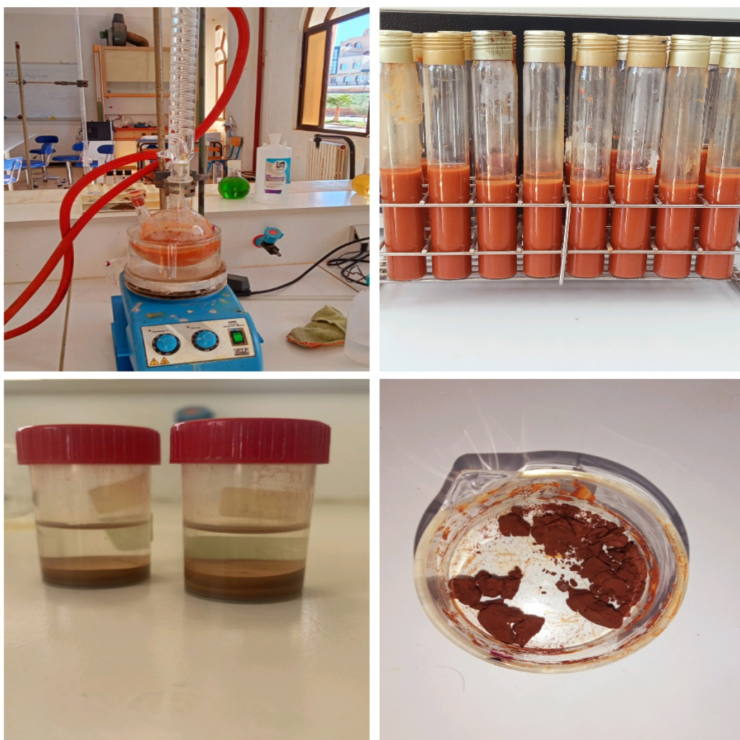
Figure II-1: Figures illustrant la préparation des ZnFe-HDL
