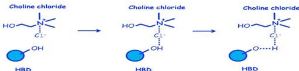
Fig. III.1 : Schéma des interactions par liaisons hydrogène entre HBA et le HBD lors de la formation des NADES.
