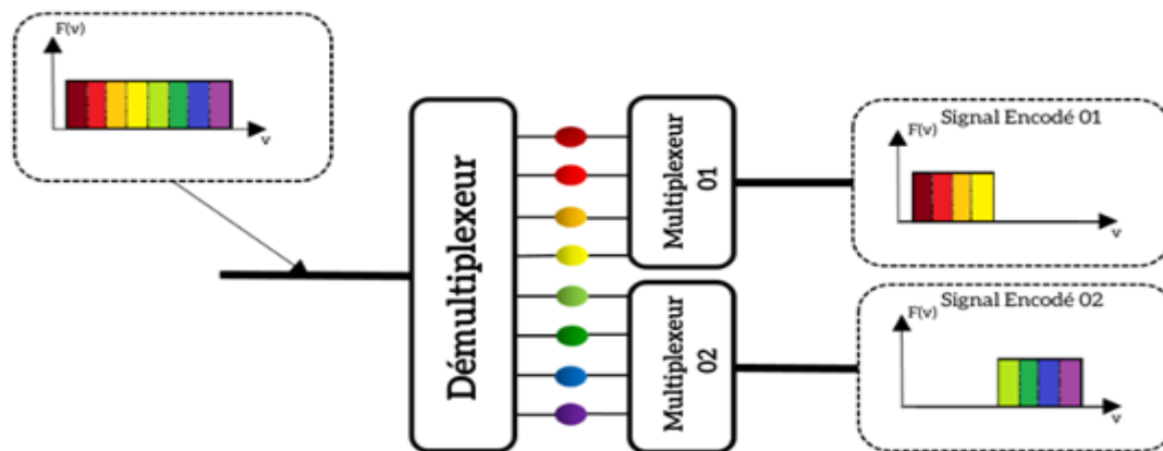
Figure I.10 : Encodage SAC-OCDMA à base d'un démultiplexeur et de multiplexeurs [1]
