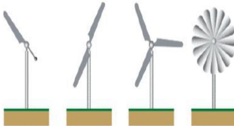
Figure I-6: Classification des éoliennes à axe horizontal selon le nombre de pales.
