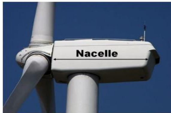
Figure I-8 : La nacelle d'une éolienne à axe horizontal.
