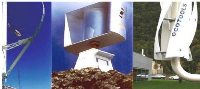
Figure I-5: Exemples des constructions Darrieus et Savonius VAWT.
