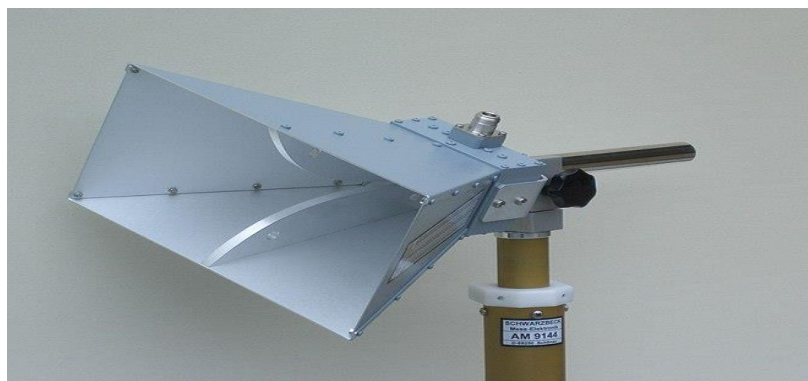
Figure I. 7: Exemple d'une antenne cornet.
