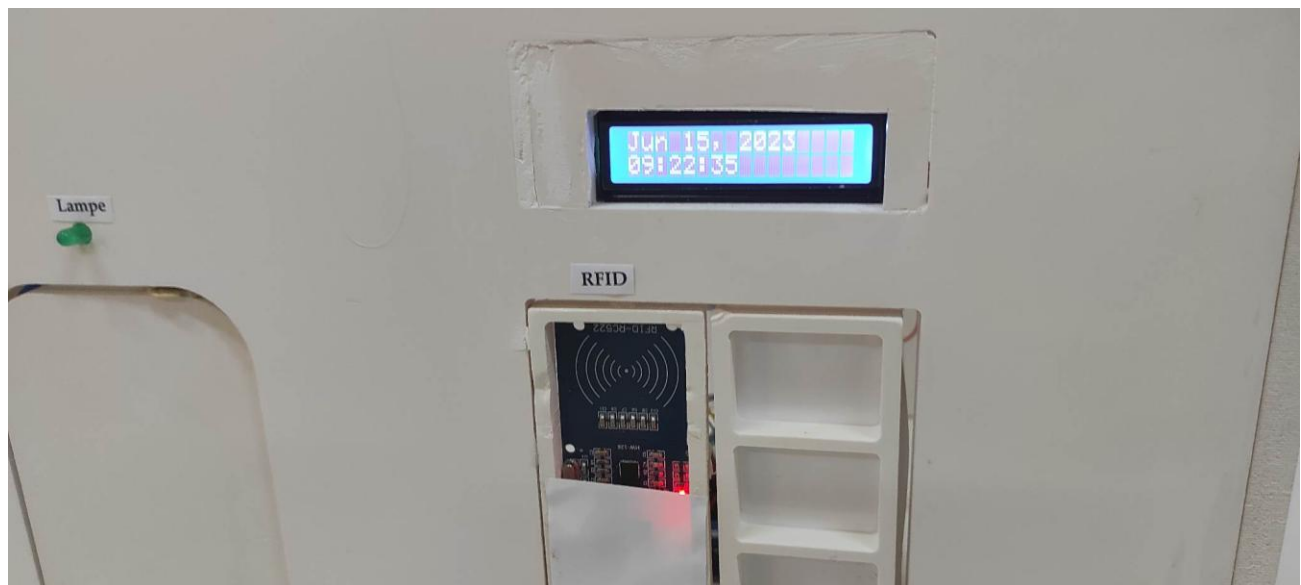
Figure 3.23 : Photo réelle sur LCD qui affiche la date et l'heure actuel.
