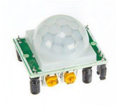
Figure 3.17 : Détecteur de mouvement HC-SR501
