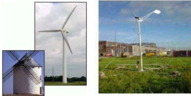
Figure I-23 Eolienne à axe horizontal (Modèle Fortis Montana)
