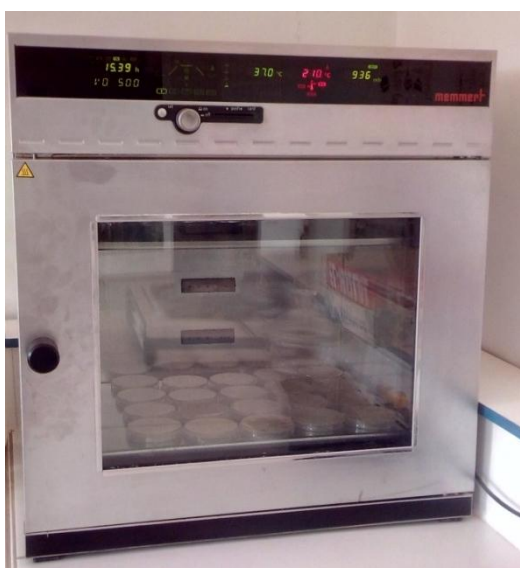
Figure B.1.6: Étuve d'incubation des bactéries.
