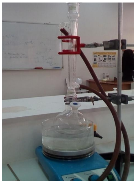
Figure B.1.2: Montage à reflux
