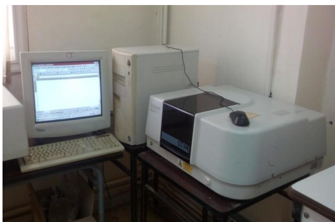
Figure B.1.7 : Spectrophotomètre IR [Shimadzu série FTIR-8300].
