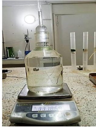
b) Pycnomètre rempli d'eau
