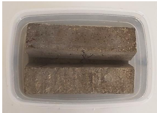
Figure V.10 : immersion des mortiers des différents ciments élaborés dans l'eau de robinet.
