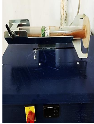
b) agitation des éprouvettes (mouvements rectilignes horizontaux)
