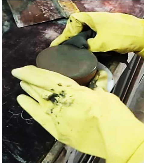
Figure II.4 : dépôt du moule sur la plaque de base.
