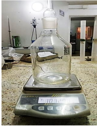
a) Pesée du pycnomètre vide
