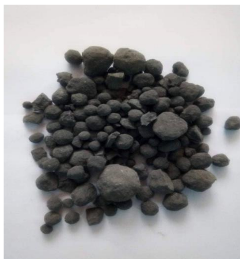
Figure III.7 : Clinker produit par la cimenterie de Saida.
