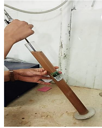
c) tube plongeur dans l'éprouvette
