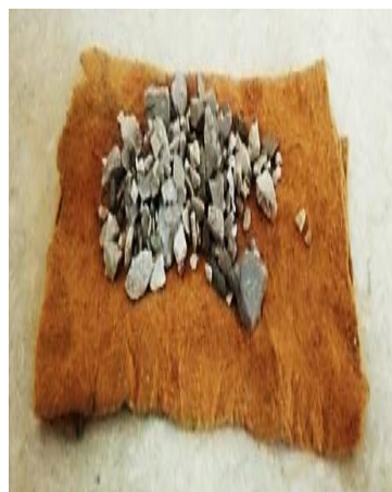
d) éponger la surface des grains de l'échantillon par un chiffon
