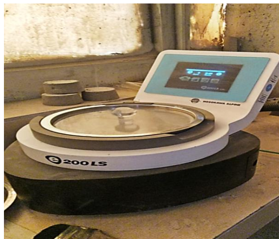
FigureII.2: Tamiseur à jet d'air Alpine type 200ls.
