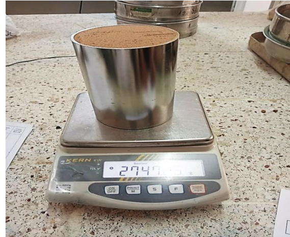
b) Pesée du Récipient rempli d'échantillon M1
