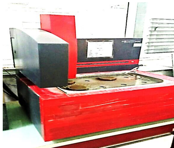
FigureII.7 : Prisomètre automatique type Toni
