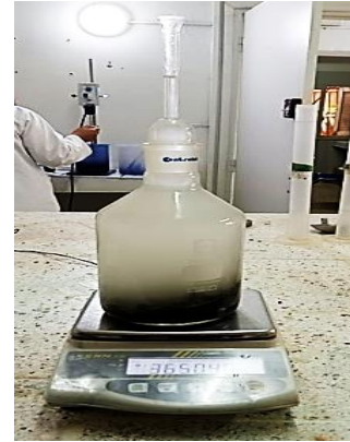
c) Pycnomètre rempli d'eau avec l'échantillon P4
