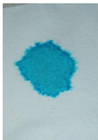
c) La tache forme une auréole teste positif
