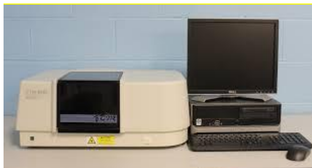
Figure IV.3: Spectrophotomètre.IR Shimadzu FTIR-8300.
