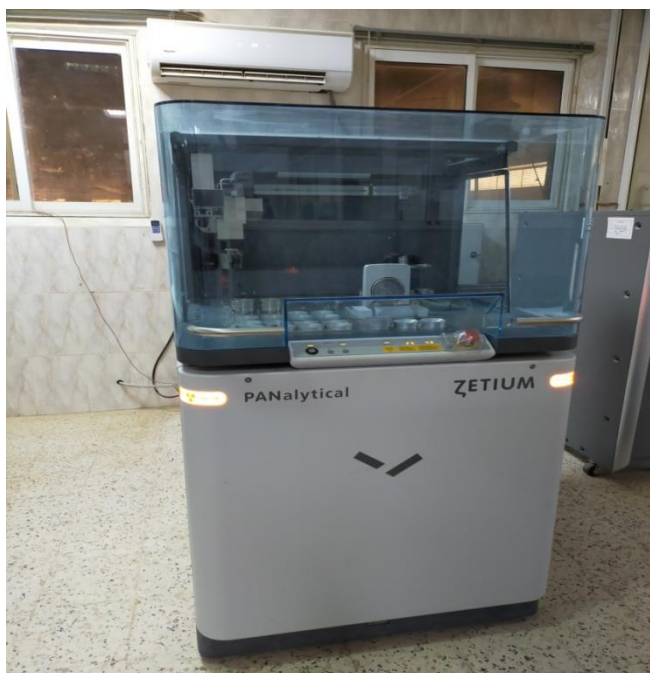
Figure II.1 : Appareil XRF de la cimenterie de Saïda
