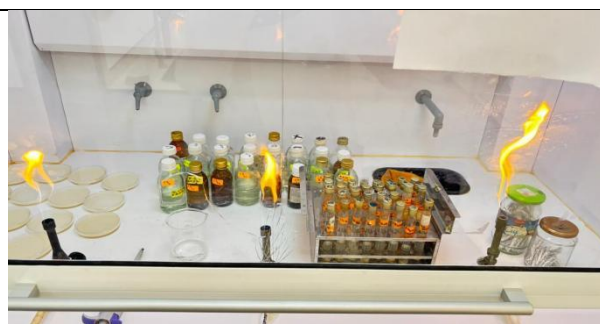
Figure 12 Test de l'efficacité conservatrice dans le shampooing (challenge test)
