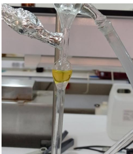
Figure 21: Récupération de l'huile essentielle de thym à l'aide de l'appareil de Clevenger
