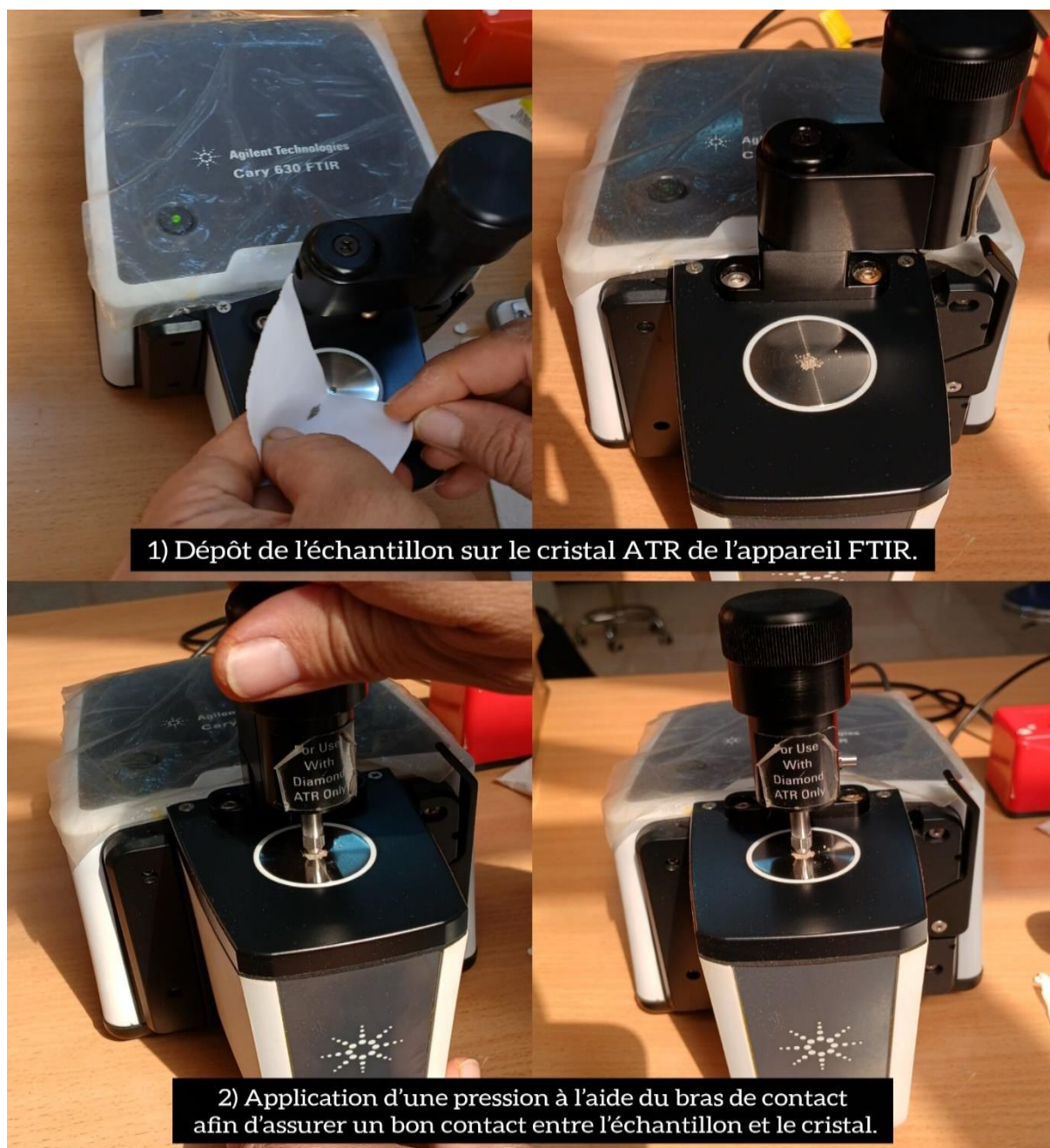
Figure 24 : Étapes de préparation physique et de mise en place de l'échantillon sur le cristal ATR (Photo réelle).
