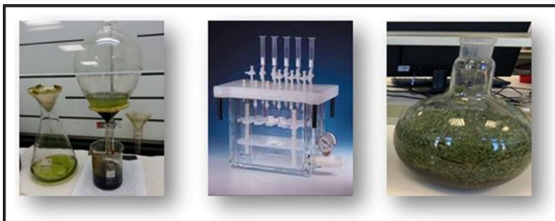
Figure 18 : Principales techniques d'extraction : extraction liquide-liquide, extraction sur phase solide et extraction solide-liquide (Ahmed et al. , 2026).
