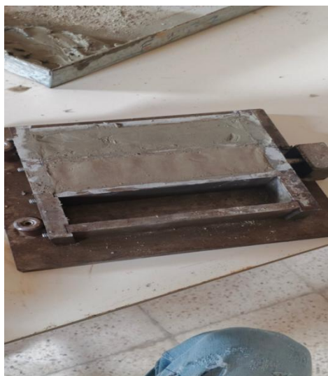
Figure 3.4.les éprouvettes avant le démoulage.
