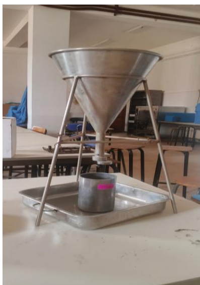
Figure 3.1. matériel utilisé pour mesure de la masse volumique.
