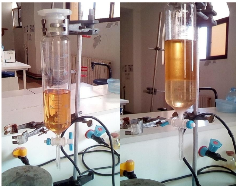
Figure B-1-4: Purification des produits synthétisés par l'extraction liquide-liquide.
