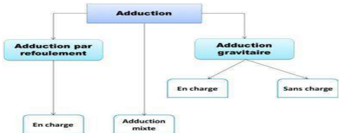
Figure IV.2 : Mode d'adduction des eaux.
