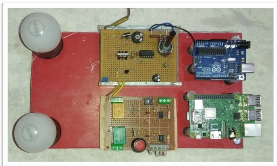
Figure IV.26. Prototype de communication entre les dispositifs de mesures et l'application de Smartphone.
