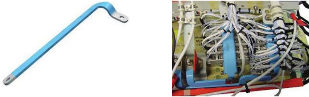
Figure II.2. À gauche, exemple d'une barre électrique - À droite, photo du bus-barre dans le cœur électrique [Gir-14].
