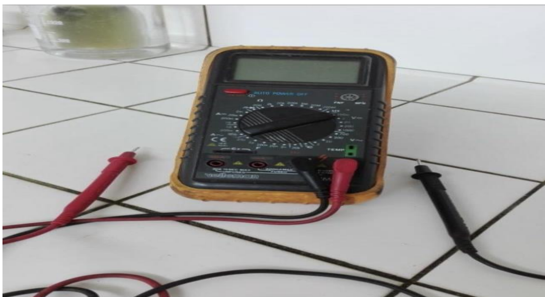
Figure 19: Millivolt utilisé pour la mesure du courant électrique.
