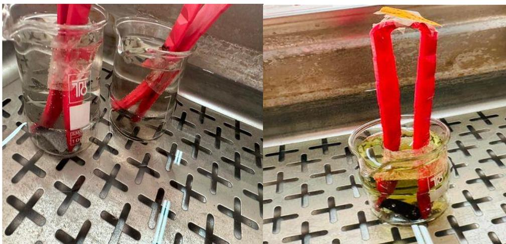
**Figure II. 5 : Immersion des pièces pendant 3 heures dans le bain thermostatique.**
