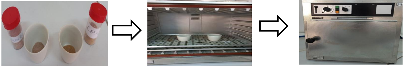
Figure II-3: séchage des matières premières dans l'étuve
