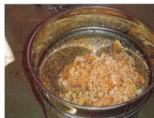
**Fig. 5 :** Filtre situé dans la partie supérieure du maturateur et servant à séparer le miel et divers débris (cire, abeilles ...) [11].
