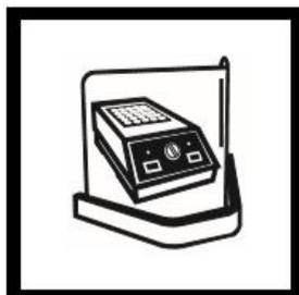
1. Mettre la chambre de réaction DCO en marche. Chauffer à 150 °C. Placer la protection en plastique devant la chambre de réaction.
