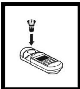
13. Introduire l'adaptateur DCO/TNT dans le puits de mesure en le faisant tourner jusqu'à ce qu'il tombe en place. L'enfoncer alors complètement.
