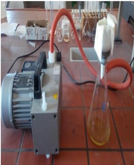
**Figure 23.** Filtration pompe sous vide
