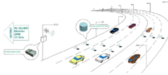
FIGURE 3.14 – Capteur magnétique sur l’autoroute[24]
