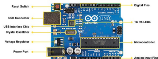
FIGURE 4.1 – description du matériel Arduino Uno[53]
