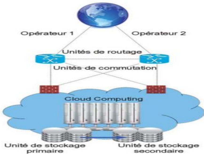
Figure 2.2 Présentation d'une architecture mono-data center [16]
