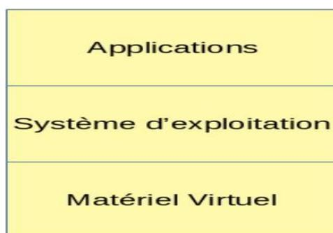
Figure I.9 : Machine Virtuelle (Zertal, 2019)
